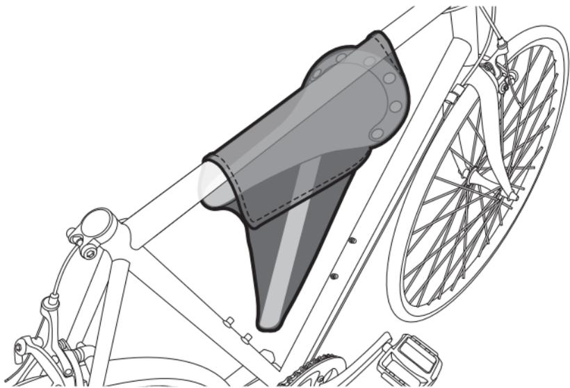
図のようにサドルケースにサドルを収納し、トップチューブに巻きつけてください。
