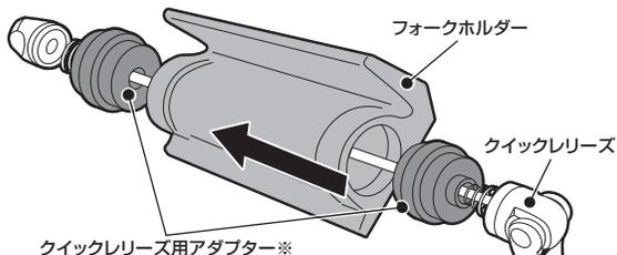
図のようにクイックリリース用アダプターとクイックリリースをフォークホルダーに取り付けます。
