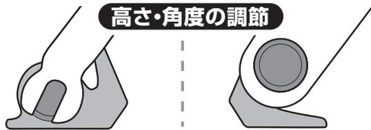
フォークエンドの形状に応じてフォークホルダーの向きを変えることで、接地面の角度や高さを調節できます。
