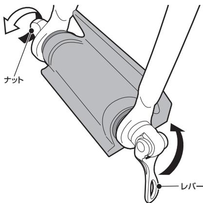
クイックリリースのナットを締め、レバーを起こして固定します。
