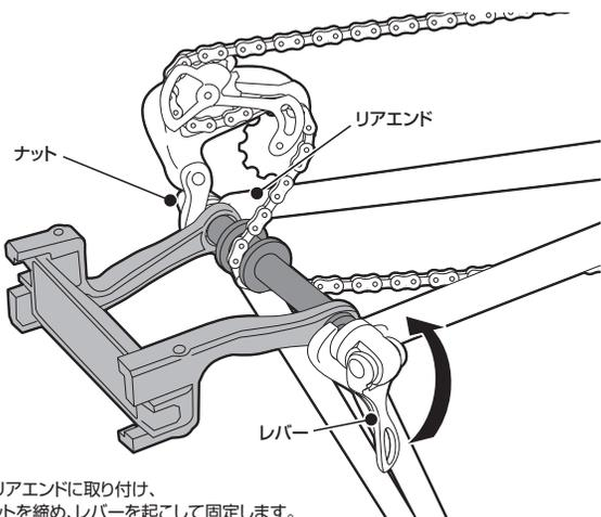
リアエンドホルダーをリアエンドに取り付け、クイックリリースのナットを締め、レバーを起こして固定します。
