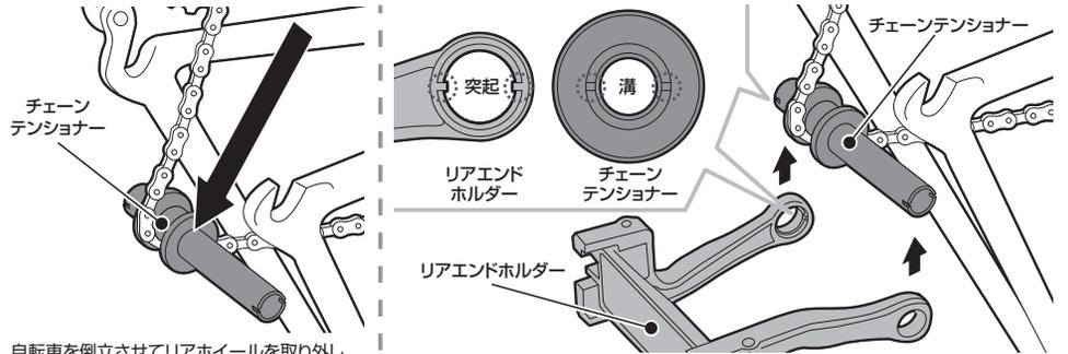
自転車を倒立させてリアホイールを取り外し、図のようにチェーンテンショナーをチェーンにかけてフレームの外に引き出します。
