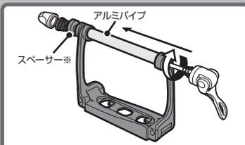
アルミパイプをアームの間に挟み、クイックリリースを取り付けます。
