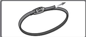
通したベルトの先端を矢印の方向に引っ張り、ループを締めます。
